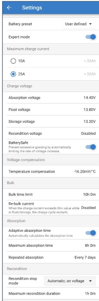
Om toegang te krijgen tot de expertmodus en het menu 'geavanceerde instellingen' uit te breiden, gaat u naar het menu 'geavanceerde instellingen' en schakelt u de schakelaar 'Expertmodus' in.
