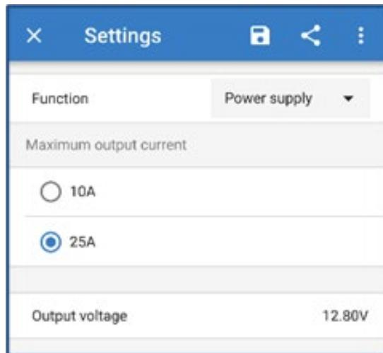
Nella modalità alimentazione è anche possibile attivare la modalità corrente bassa o la modalità notturna e specificare la tensione in uscita desiderata.
