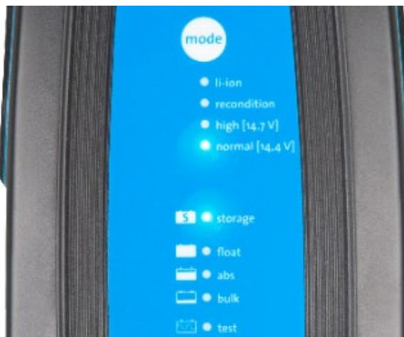
Il caricabatterie memorizza automaticamente la modalità di carica selezionata e la ricorda per i cicli futuri (anche dopo una disconnessione dall'alimentazione).
