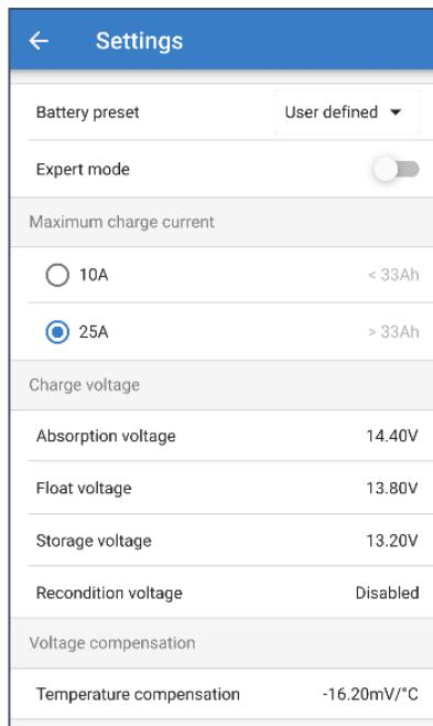
Om toegang te krijgen tot het menu 'geavanceerde instellingen', opent u het menu 'algemene instellingen' en schakelt u de schakelaar 'Geavanceerde instellingen' in en selecteert u 'Geavanceerde accu-instellingen'.
