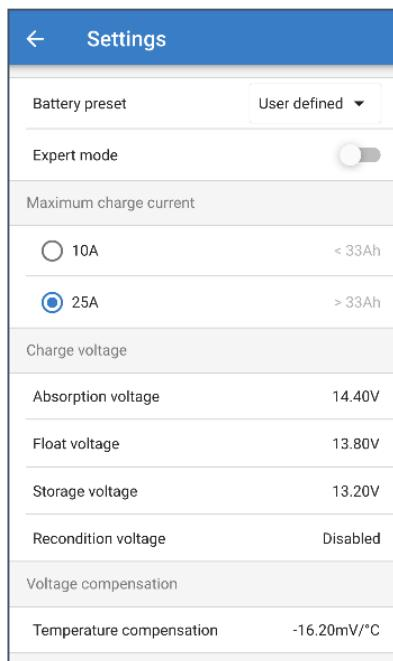
Pour accéder au menu de configuration avancée, ouvrez le menu de configuration générale, et activez le bouton de configuration avancée (« advanced settings »), puis sélectionnez les paramètres avancés de batterie (« Advanced battery settings »).
