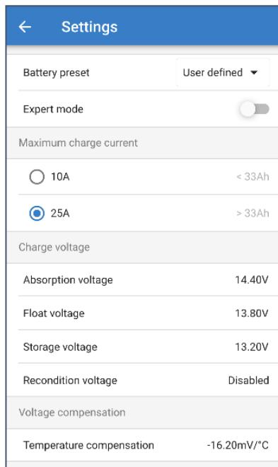
Para acceder al menú de ajustes avanzados, abra el menú general de ajustes, habilite el interruptor de 'Advanced settings' (ajustes avanzados) y seleccione 'Advanced battery settings' (ajustes avanzados de la batería).
