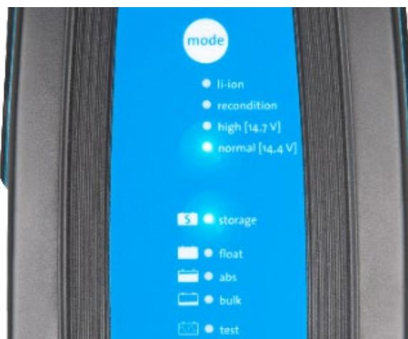
Le chargeur stockera automatiquement le mode de charge sélectionné, et l'utilisera à nouveau pour les prochains cycles de charge (même après avoir été débranché de l'alimentation).
