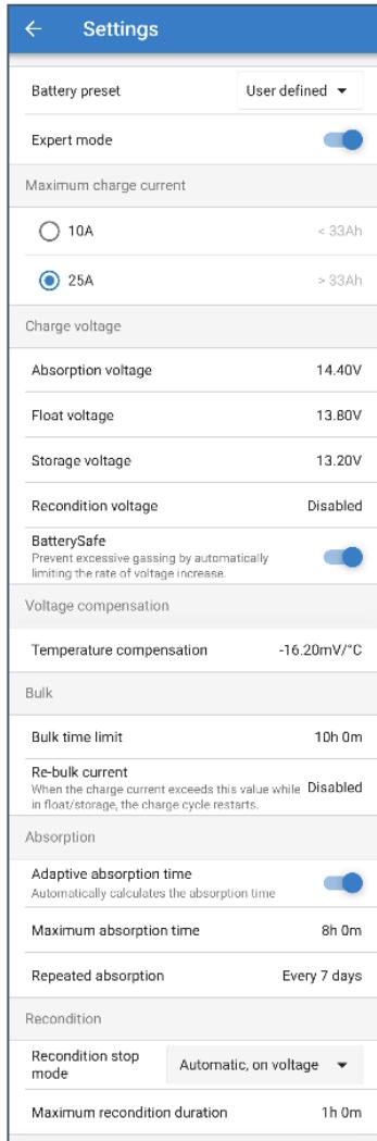
Pour accéder au mode Expert et disposer de davantage de paramètres avancés, entrez dans le menu de Configuration avancée et activez le mode Expert.
