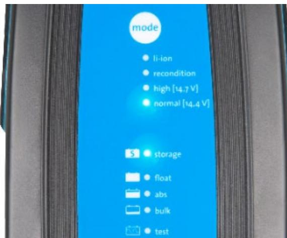
O carregador guardará automaticamente o modo de carregamento e recuperá-lo para ciclos de carregamento posteriores (mesmo depois de ter sido desligado da alimentação elétrica).
